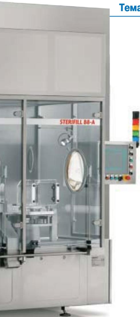
Большим преимуществом для производства по выпуску лекарственных препаратов в ампулах различного размера является то, что перенастройка оборудования можно выполнять очень быстро и без использования специальных инструментов,
