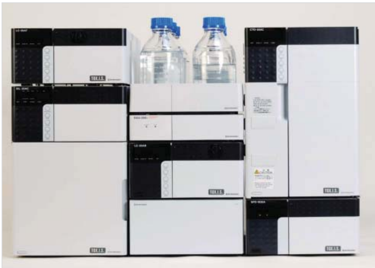
Фото № 1. Автоматизированная аналитическая система TOX.I.S.™ на базе жидкостного хроматографа SHIMADZU серии LC-20
