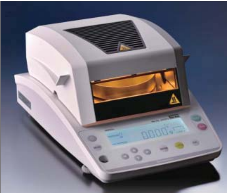
Фото № 5. Гравиметрический измеритель содержания влаги SHIMADZU модели MOC-63U
