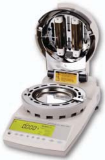
Фото № 4. Гравиметрический измеритель содержания влаги SHIMADZU модели MOC-120H
