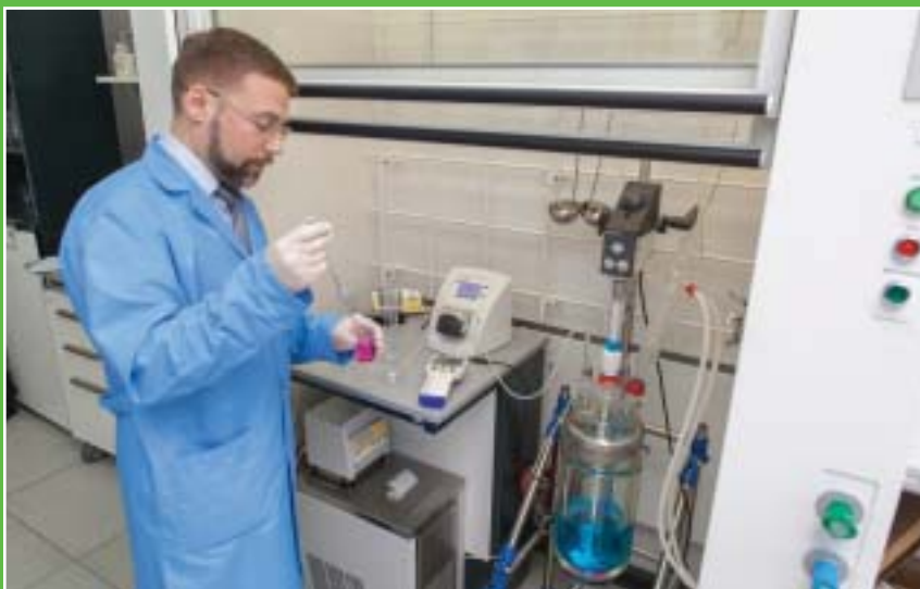
Реактор для масштабирования синтетических проектов Radleys, Великобритания
