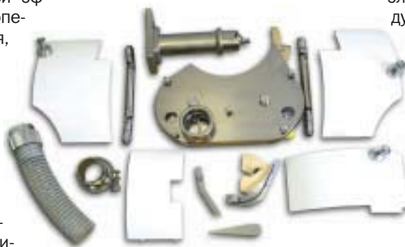
Рис. 2. Набор компонентов для быстрой смены форматов
