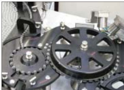
groninger UFV: транспортная и проверочная станция
