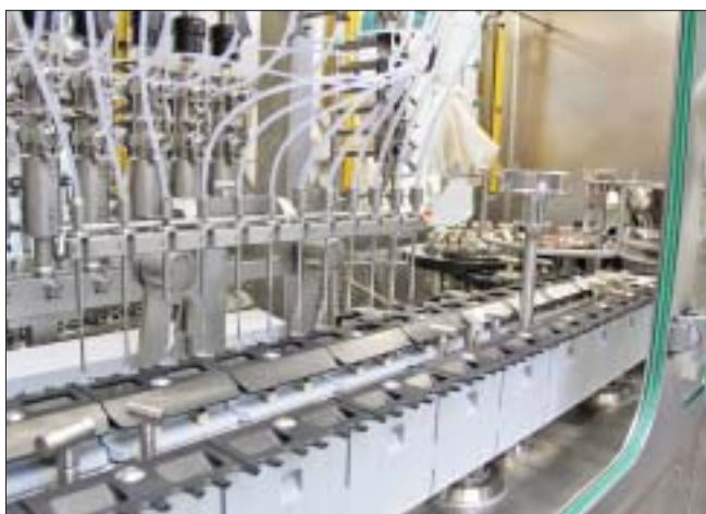
groninger UFVK 6005, станция розлива
