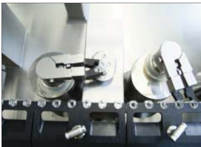
Станция проверки groninger: контроль в процессе изготовления
