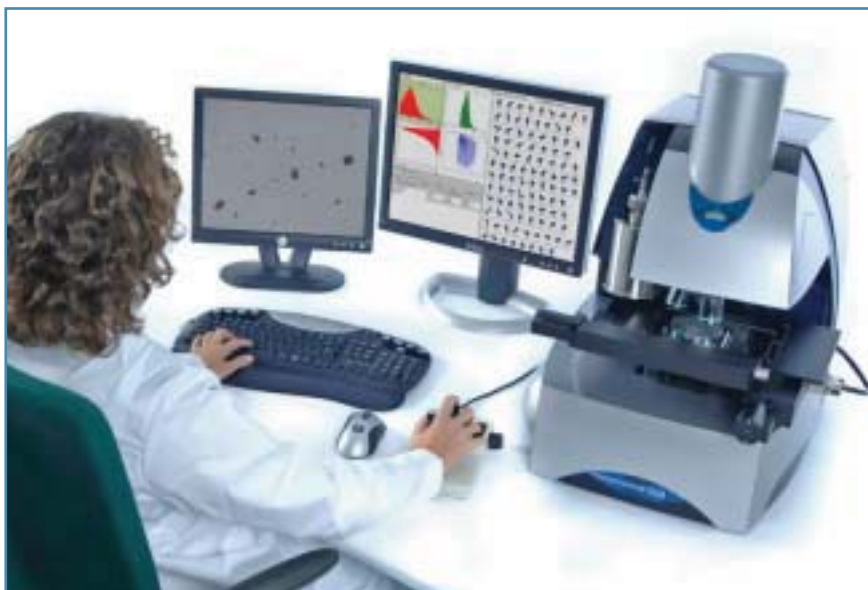
Рис. 4. Morphologi G3 Malvern Instruments – анализатор формы и размера частиц
