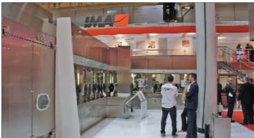
Рис. 12. Флаконная линия EXTREMA в изоляторном исполнении, охватывающая стадии от подготовки первичной упаковки до розлива и лиофилизации, IMA (Италия) (фото с выставки interpack-2011)
