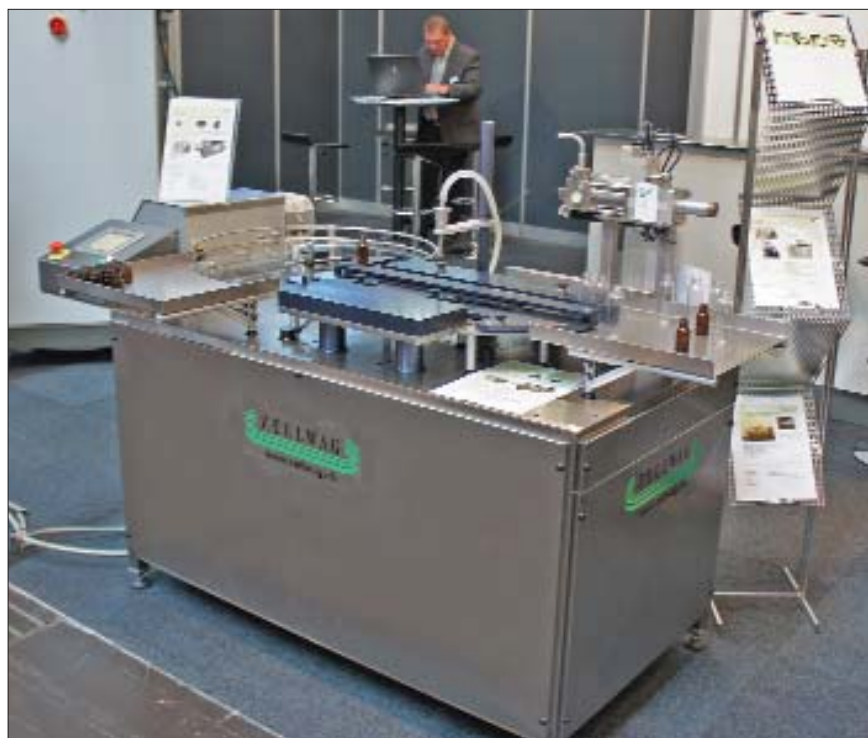
Рис. 16. Универсальная фасовочная и укупорочная машина со сменной дозирующей станцией для жидких, мягких и твердых (в т. ч. и порошков) лекарственных форм, Zellwag (Швейцария) (фото с выставки interpack-2011 )
