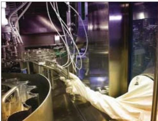
Рис. 1. Комбинированная установка асептического розлива молока, Sidel (Франция) ( www.sidel.com )
