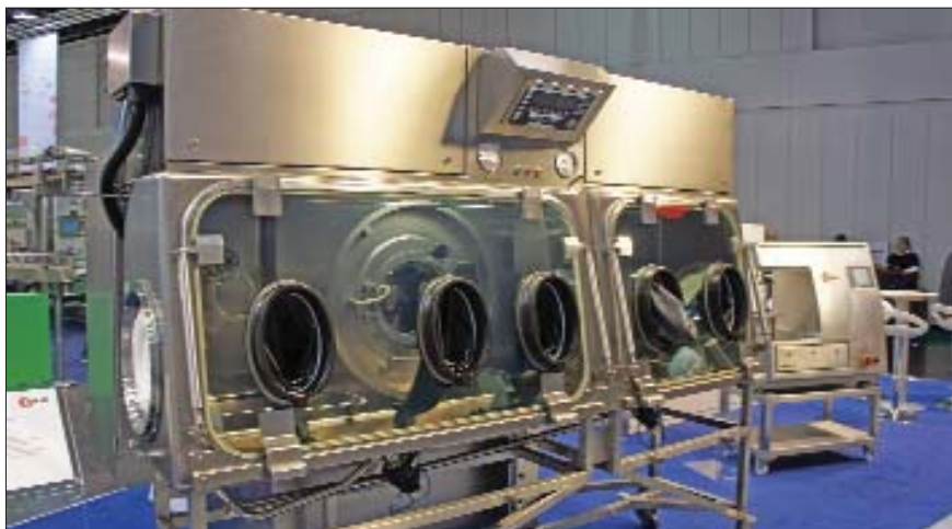
Рис. 11. Установка для нанесения оболочки в изоляторном исполнении, Glatt GmbH (Германия) (фото с выставки interpack-2011)
