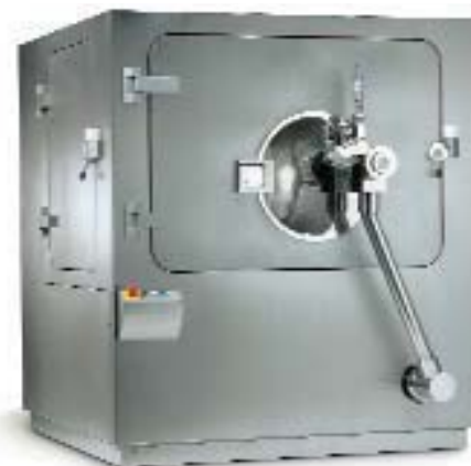
Рис. 3. Установка для нанесения оболочки Perfima, IMA (Италия) (фото предоставлено компанией IMA)
