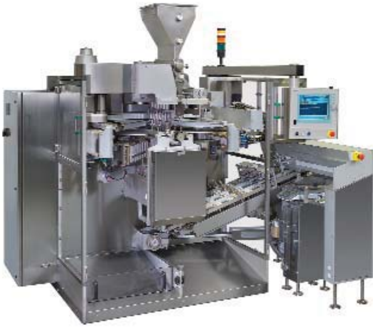
Рис. 5. Машина для фасовки продукта в саше MS235, Marchesini (Италия) (фото предоставлено компанией I.E.S. International B.V.)
