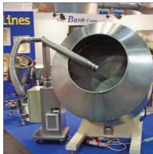
Рис. 4. Дражировочный котел, Soc. Base Coop. s.r.l. (Италия) (фото с выставки interpack-2011)
