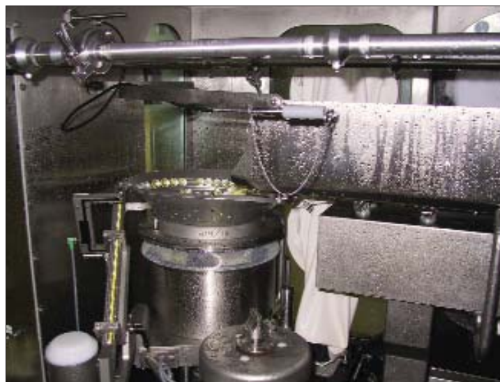
Рис. 15. Ручная мойка и дезинфекция установки для токсичного производства посредством прочно зафиксированных распылительных головок и H 2 O 2 (источник: groninger)
