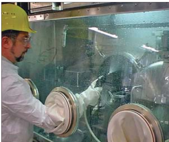
Рис. 14. Ручная мойка и дезинфекция установки для токсичного производства посредством распыления и протирания (источник: SKAN)
