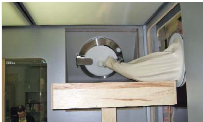
Рис. 6. На такой модели возможно, например, протестировать количество и размещение перчаток и портов быстрой транспортировки – RTP-портов (источник: Франц Циль)
