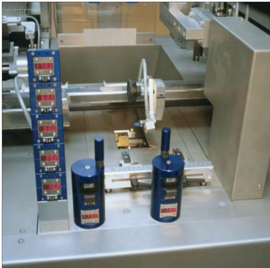
Рис. 2. Цифровой дисплей для быстрой и точной замены типа упаковки
