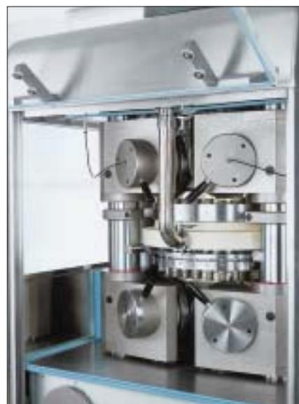
Быстрое и простое открывание как верхнего, так и нижнего прижимного ролика обеспечивает легкий доступ к компрессионной зоне и значительно сокращает время смены формата ■
