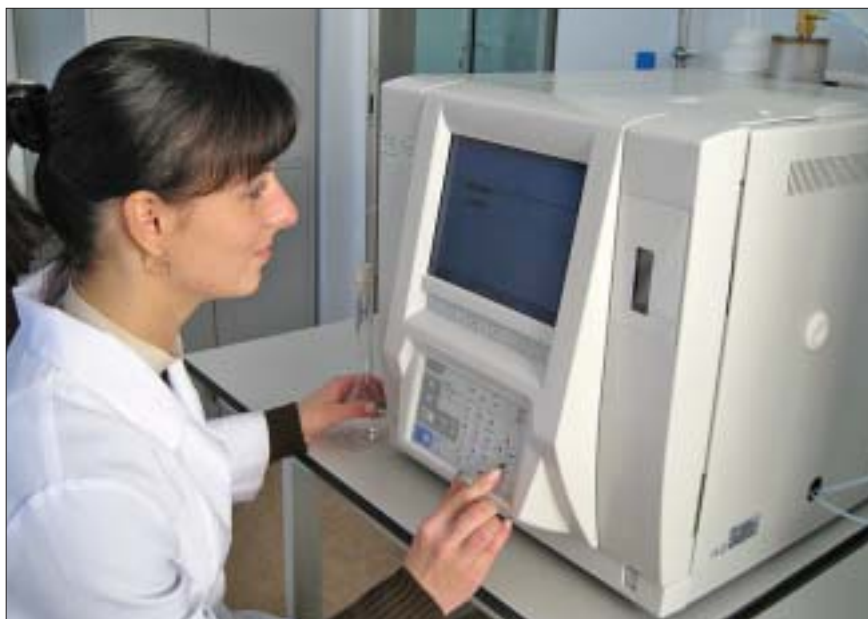
Фото № 1. Выполнение измерений на ТОС-анализаторе SHIMADZU модели TOC-V CSN в лаборатории фармацевтического предприятия «НИКО»
