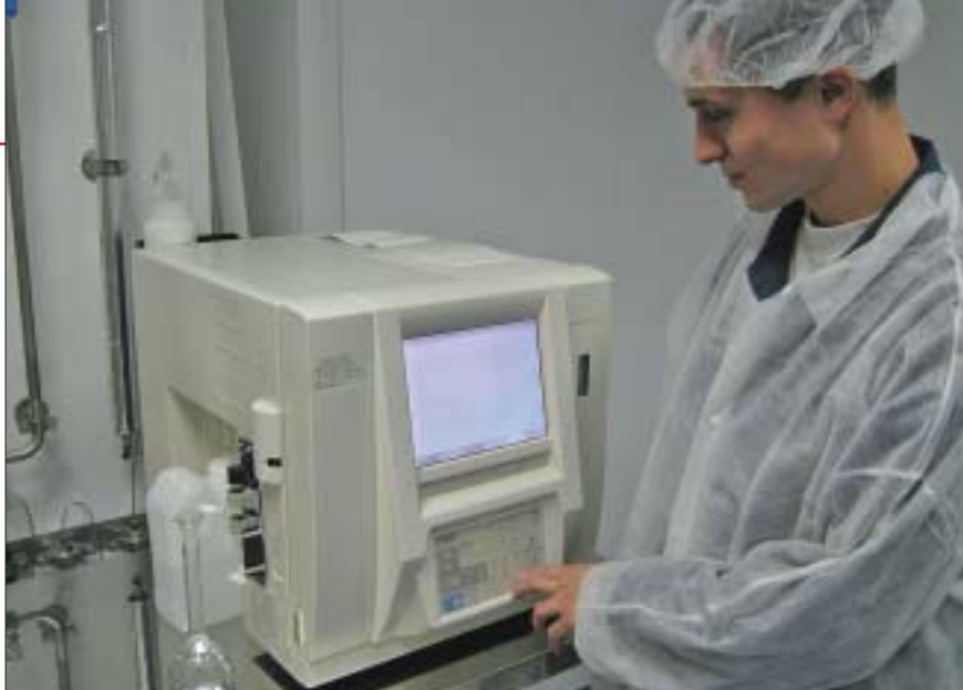
Фото № 2. Выполнение измерений на TOC-анализаторе SHIMADZU модели ON-LINE TOC-V CSH в лаборатории фармацевтического предприятия «Киевмедпрепарат»
